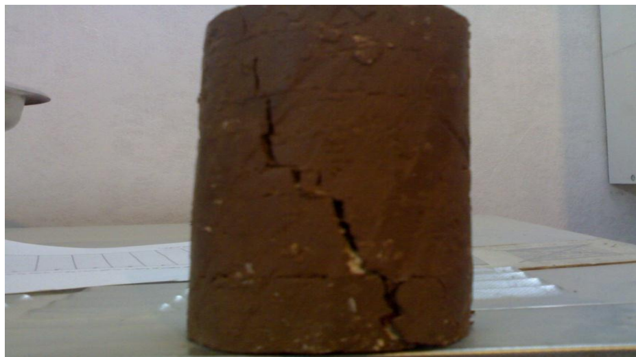
الشكل ٤-٥: عينة مختبرة بواسطة جهاز الضغط غير المحصور
