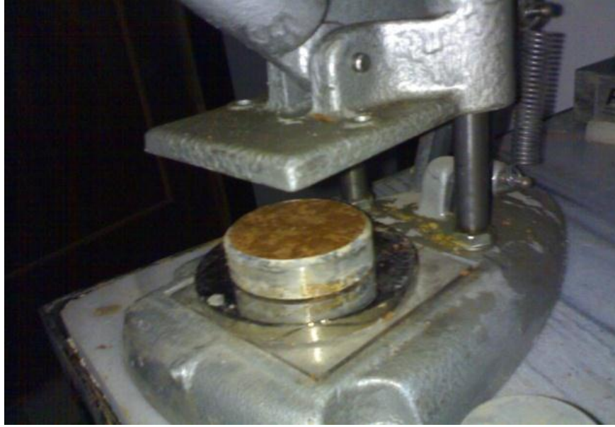
الشكل ٤-٦: تحضير عينة تربة معادة التشكيل .
