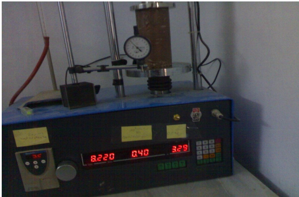
الشكل ٣-٤: جهاز قياس الضغط غير المحصور المستخدم
