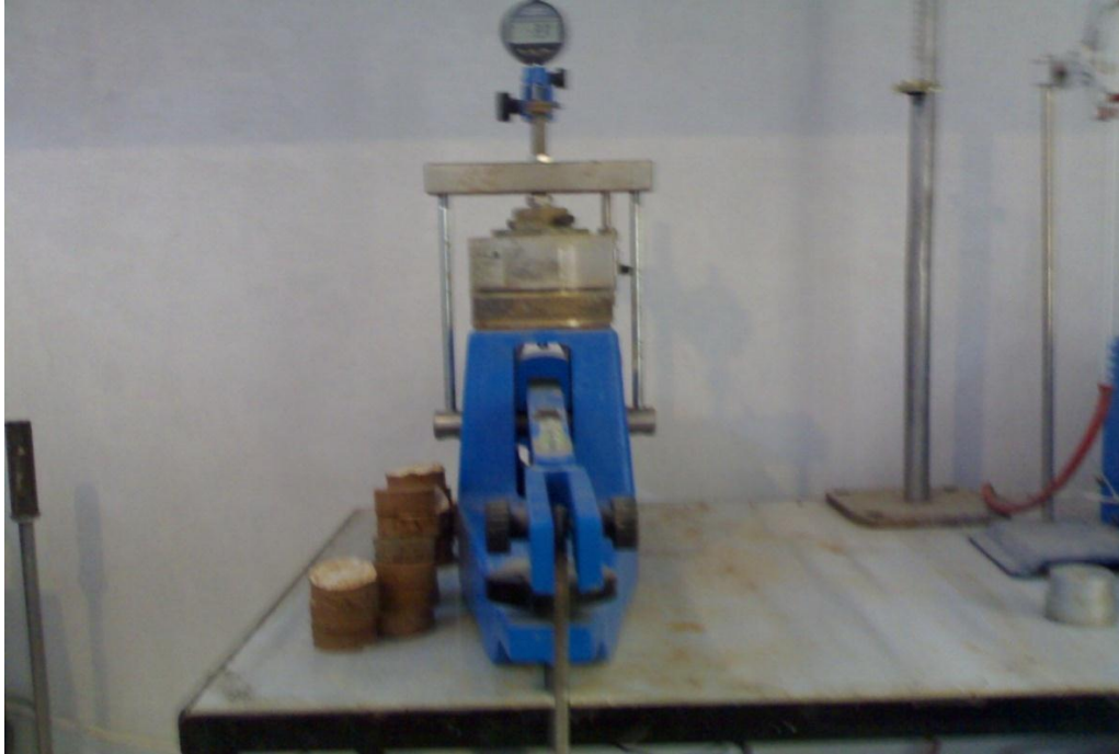
الشكل ٣-٥: جهاز الأدمتر المستخدم في قياس ضغط الانتفاخ
